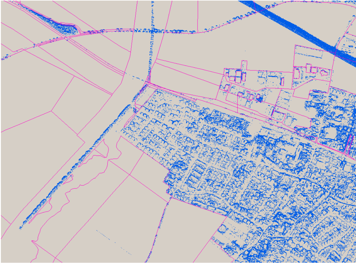
Abbildung 5: Ergebnis der Verschattungsberechnung in der Freiflächenanalyse. Die blauen Bereiche signalisieren mehr als 20 % Verschattung.
